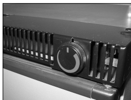
Termostatplacering på CR 100, till höger i ventilationsgallret över dörren.
