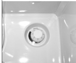
Plaatsing thermostaat in CR 65, op achterwand rechts van het koelvak.
