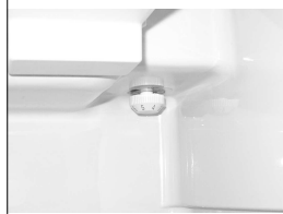
Termostatplacering i CR 49, på bakre horisontell vägg till höger om köldfacket.
