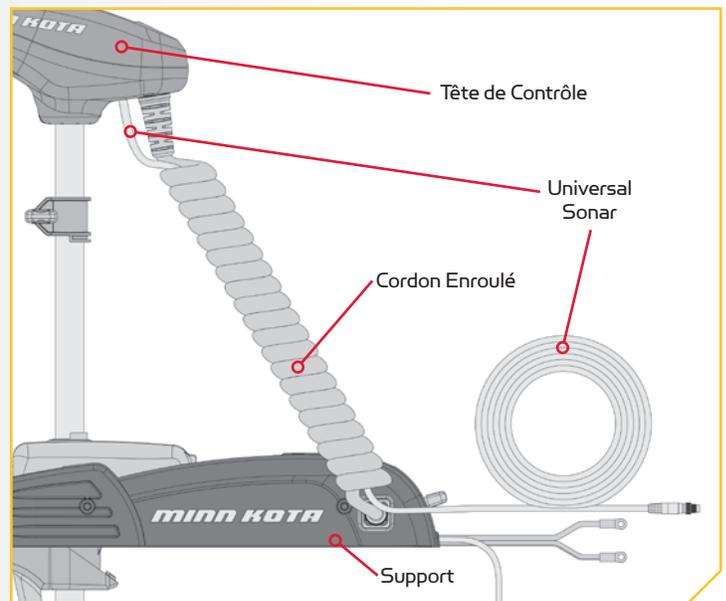
**REMARQUE:** Après que le câble de l'Universal Sonar ait été sorti du cordon enroulé, il doit être acheminé par un système d'acheminement établi sur le bateau, dans une zone libre d'interférences. Inspectez bien le chemin planifié pour vous assurer qu'il n'y a pas d'arêtes vives, d'obstacles ou d'obstructions qui pourraient endommager les câbles.
