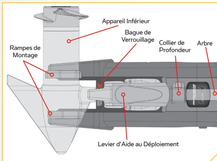
**REMARQUE:** Glissez le collier de profondeur vers le bas et fixez-le contre la partie supérieure du boîtier de direction lorsqu'en position arrimée, pour tenir le moteur en place et empêcher un déploiement accidentel.
