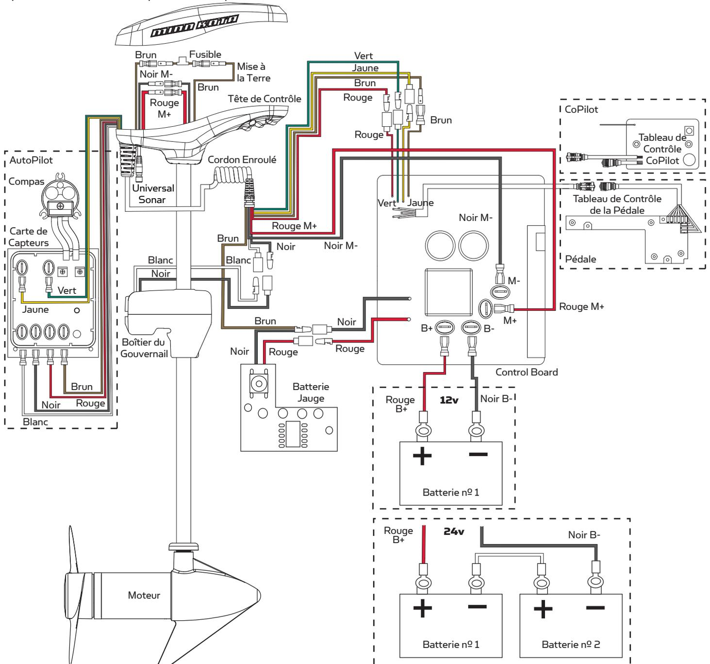
**REMARQUE:** Il s'agit d'un schéma multi-tensions. Revérifiez la tension de votre moteur afin d'effectuer les raccordements appropriés. Les dispositifs de protection contre la surintensité ne figurent pas dans cette illustration. Si équipé d'un Universal Sonar, veuillez consulter la fiche d'instructions sur le site Web [minnkotamotors.com](http://minnkotamotors.com).
