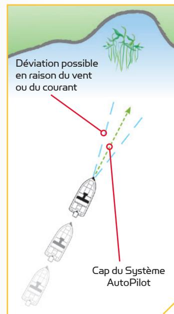
**REMARQUE:** Après avoir établi une nouvelle orientation, il y a un court délai avant que l'orientation ne soit verrouillée, afin de permettre à la boussole de se stabiliser. Lors de grands changements de vitesse, le cap du système AutoPilot pourrait changer légèrement. C'est normal.
