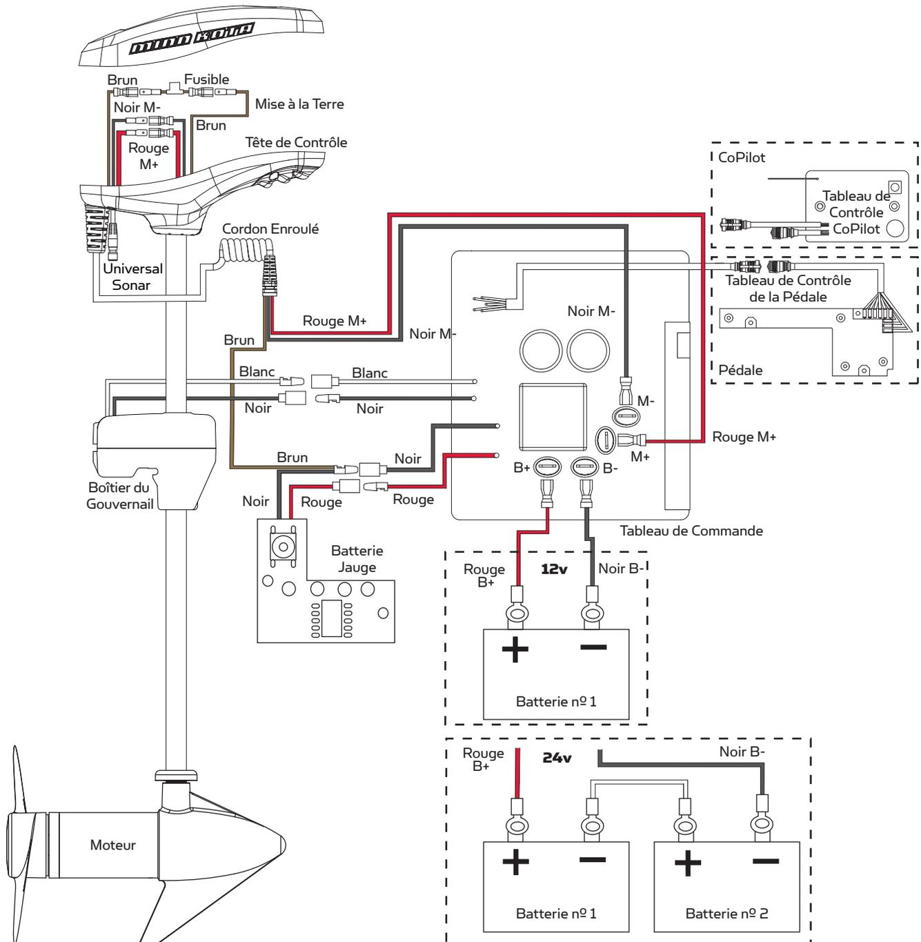
**REMARQUE:** Il s'agit d'un schéma multi-tensions. Revérifiez la tension de votre moteur afin d'effectuer les raccordements appropriés. Les dispositifs de protection contre la surintensité ne figurent pas dans cette illustration. Si équipé d'un Universal Sonar, veuillez consulter la fiche d'instructions sur le site Web [minnkotamotors.com](http://minnkotamotors.com).
